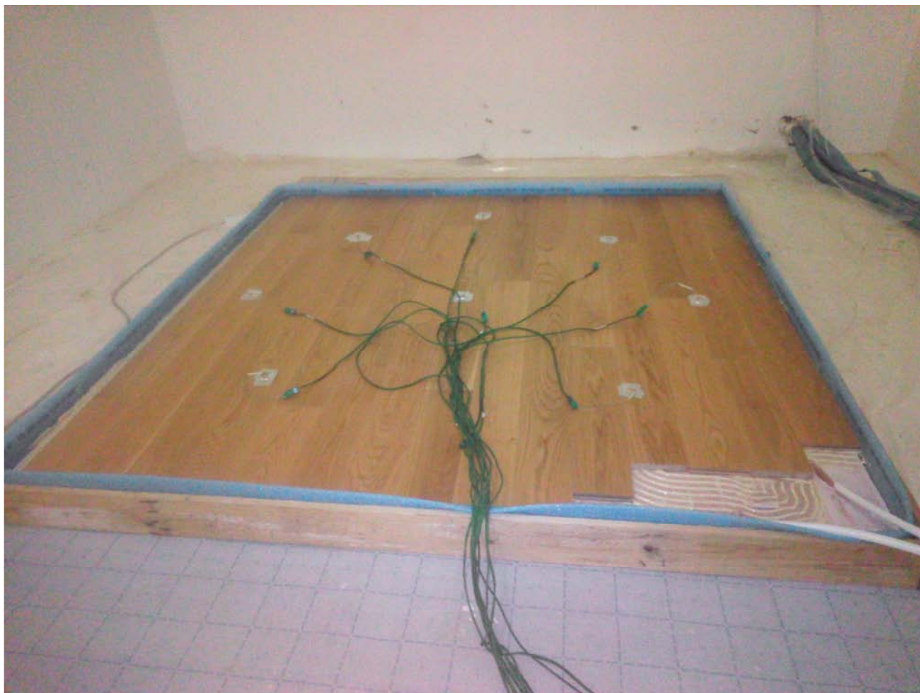
Sistema Uponor 84 mm. Conexiones de termopares en el suelo.
